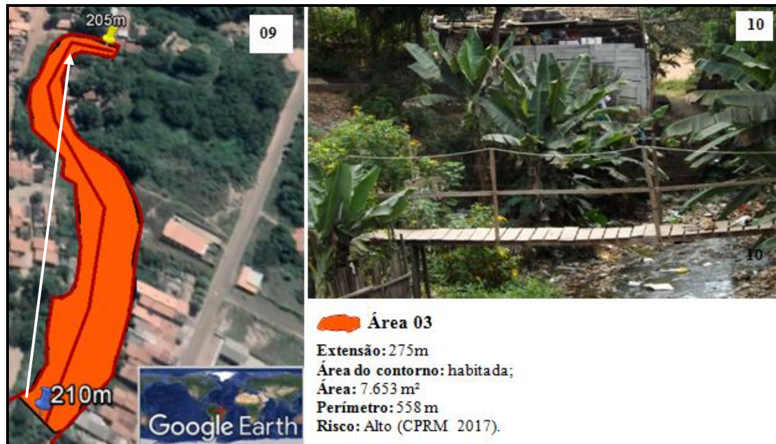
Figura 24: Principais aspectos por área da Voçoroca do Bairro Centro. (09) Região terminal da voçoroca (Área 03), com presença de canal com água (10). (11) Visão geral desta porção da voçoroca e o comprometimento das moradias do entorno.
